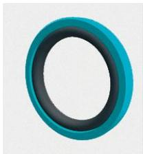
Turcon® Glyd Ring® y Turcon® Glyd Ring® T constituyen un dispositivo excelente de control de fugas para aplicaciones con pistones y vástagos, además de presentar una buena resistencia a la extrusión. Estas juntas de doble efecto activadas por juntas tóricas se destinan primordialmente a aplicaciones dinámicas, donde ofrecen una gran resistencia al desgaste. Sus
