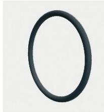
Las juntas tóricas FEP son una opción adecuada en aquellas aplicaciones donde se requiere una junta con un alto grado de compatibilidad química. Estas juntas están formadas por un anillo interior de elastómero, encapsulado dentro de un tubo de tetrafluoroetileno hexafluoropropileno (FEP) sin soldaduras. La capa exterior de FEP ofrece una resistencia química similar al
