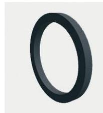
Trelleborg Sealing Solutions es proveedor de las juntas originales QUAD-RING®. Se trata de una junta de cuatro labios con un perfil de estanquidad de diseño especial. A diferencia de las juntas tóricas, estas juntas no se retuercen en el alojamiento, poseen unas características de fricción mejoradas y ofrecen un rendimiento de estanquidad superior en algunas aplicaciones.
