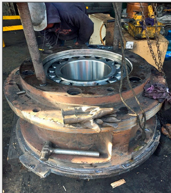
Montaje de rodamientos de rodillos de molienda
