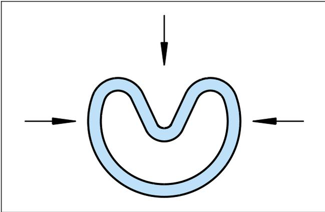
Figura 10 Deformación en forma de riñón
