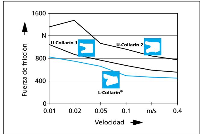
Figura 30 Fricción en función de la velocidad
