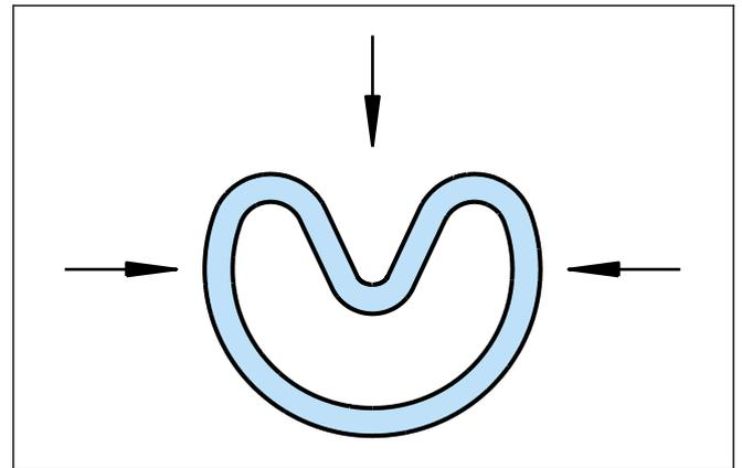
Figura 6 Deformación en forma de riñón
