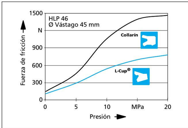
Figura 29 Fricción en función de la presión
