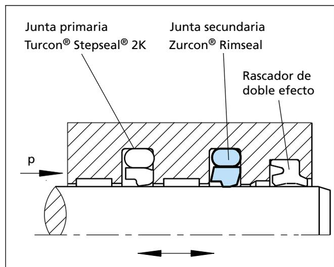
Figura 21 Zurcon® Rimseal® en configuración tándem
