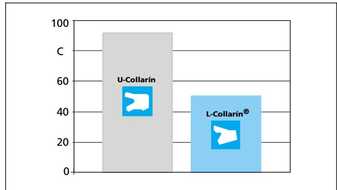
Figura 31 Aumento de temperatura generado por fricción
