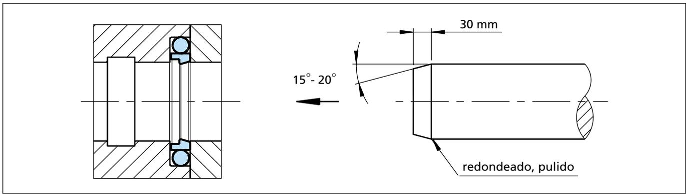
Figura 9 Calibración de la junta ya montada
