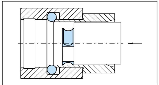
Figura 12 Introducción con un tubo empujador
