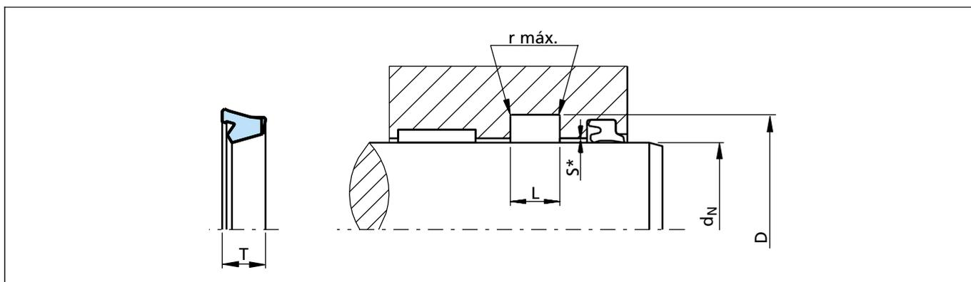
Figura 34 Esquema de instalación
